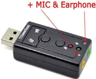
Desde la versión 5 de Android en adelante, su Kernel ya permite el uso de estas placas. En la entrada de micrófono de dicha placa deberá colocar la punta de prueba que Ud. puede construir muy fácilmente, siguiendo el esquema de la figura 22. La máxima tensión que se puede aplicar a la entrada de la tarjeta de sonido es de 1,44Vpp y como esta punta es divisora x10 y x100, podrá tener una tensión máxima de 144V.
