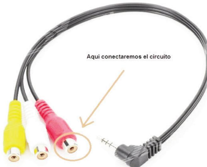
Debemos comprar un cable auxiliar con conector mini-plug de 3.5mm y con los RCAs que incluyan la opción de video, figura 28. En mi caso, usé un cable que yo tenía y que había modificado antiguamente poniéndole en el RCA rojo un conector hembra para usarlo con otros fines, el funcionamiento es el mismo, figura 29.
