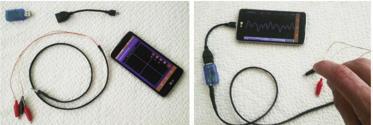
Ahora, busque una fuente de señal y aplíquela en la punta de prueba. Haga PLAY en la aplicación y disfrute de su osciloscopio. En la figura 24 se pueden apreciar varias imágenes de este osciloscopio.
